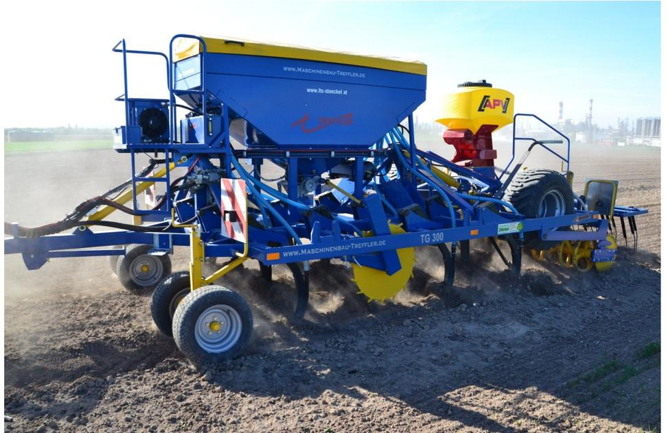
feuchten Kluten nach oben gefördert. Des Weiteren ist er durch seine Überlappung der Schare von 8cm sehr gut für Klee- und Grasumbruch geeignet. Er schneidet alle Klee-, Luzerne-, Gras-, Ampfer- und Unkrautwurzeln flach ab, und damit den Durchwuchs verhindert. Der Grubber ist verstopfungsfrei und kann auch bei sehr hohen und sperrigen Ernterückständen, z.B. Lagergetreide bzw. Körnermaisstroh eingesetzt werden. Auch zweimal Fahren macht keine Probleme.
